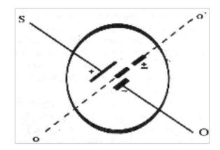
Cuando la corriente pasa por el circuito se produce en ese dispositivo un bombardeo electrónico del cátodo hacia el ánodo. Si la placa transversal está polarizada positivamente, los electrones siempre serán conducidos hacia el ánodo y la corriente pasará. En cambio, si está polarizada negativamente, los electrones negativos que provienen del cátodo serán rechazados por la placa negativa y la corriente ya no pasará.
